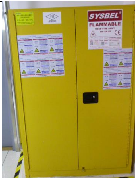
图2-1 实验室安全储存柜
