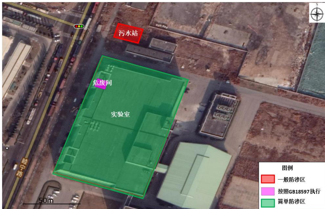
图 4-6 本项目地下水污染防治分区图
