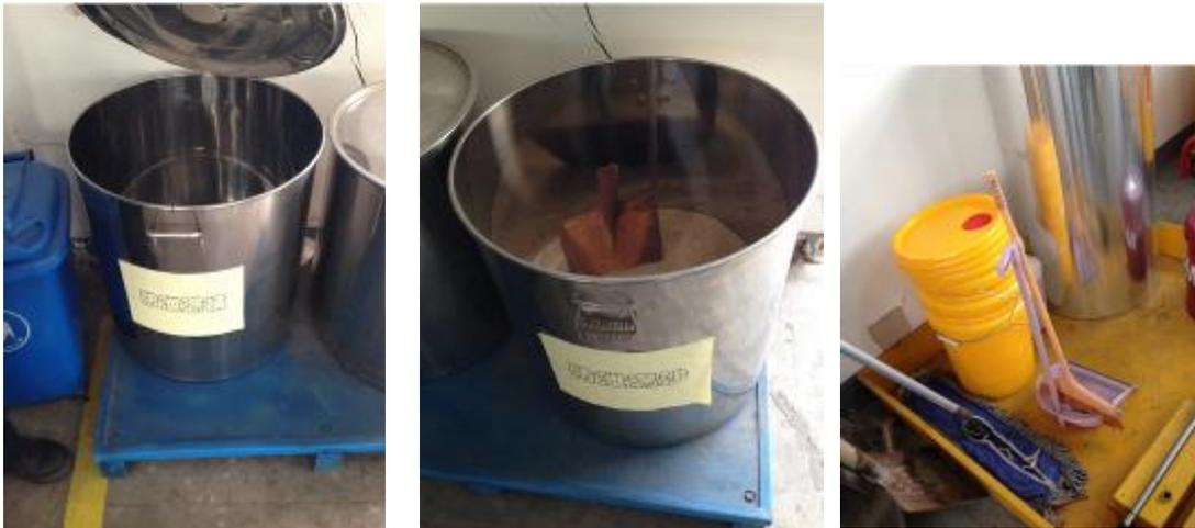
危废库房内的处置危废洒漏用的收集桶、砂土等材料及工具
