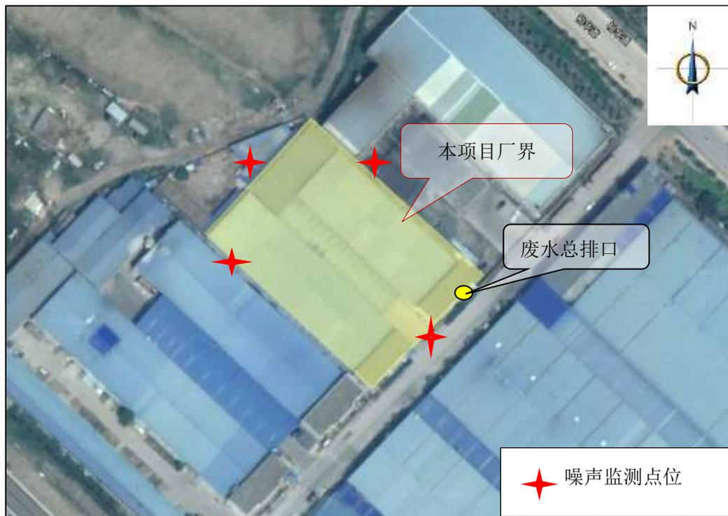
图 6-1 本项目验收噪声/废水监测点位图 (1:2000)
