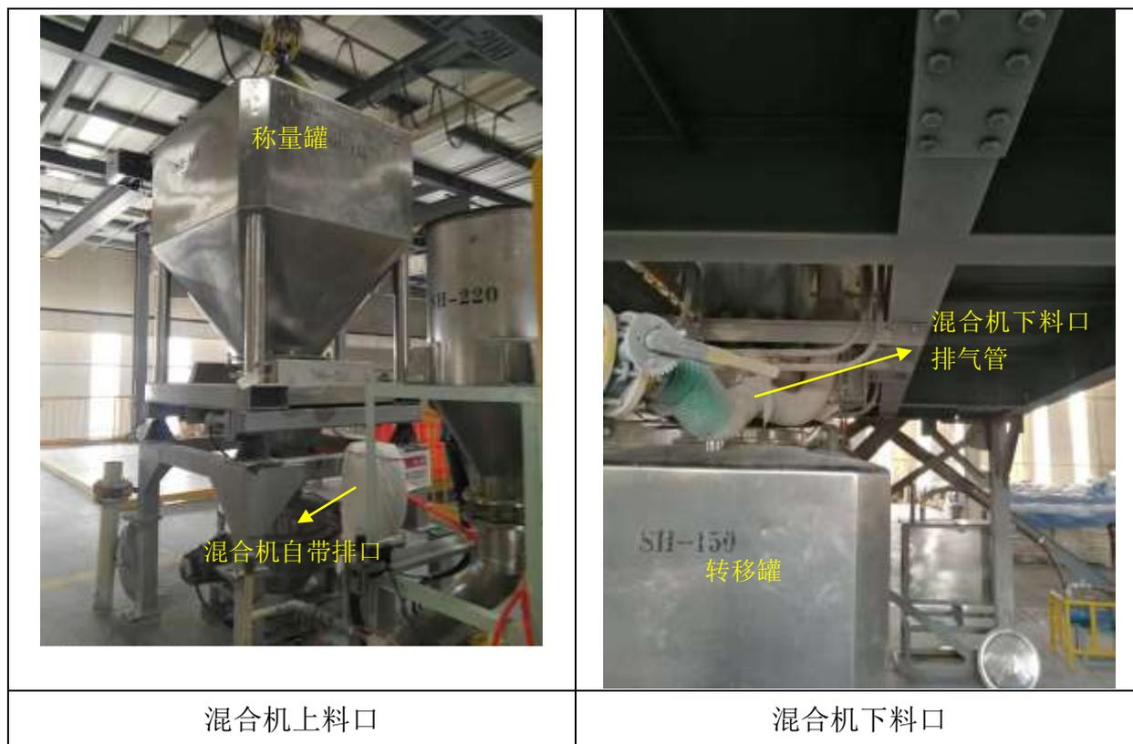
图 3-1-5 混合机上料、下料口示意图
