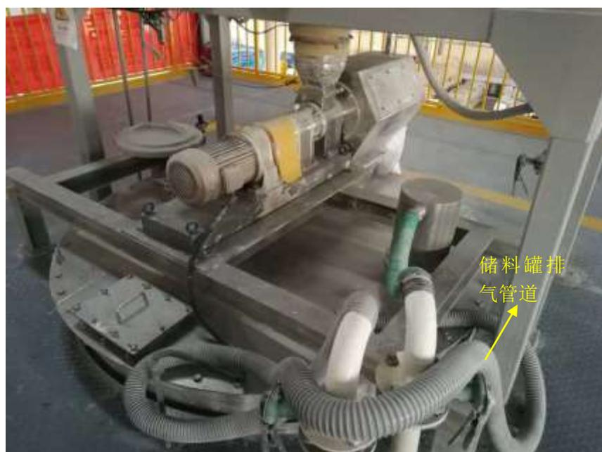
图 3-1-6 储料罐上料口示意图
