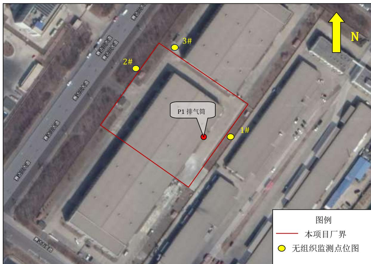
图 2-1-3 厂区现状废气监测点位示意图
